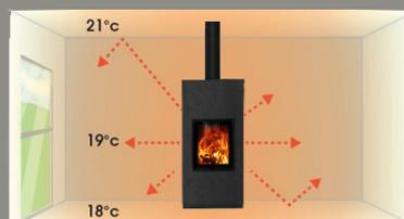
En diffusant les calories par rayonnement, le poêle TERRASTONE ne provoque pas de brassage d'air et de poussière.
